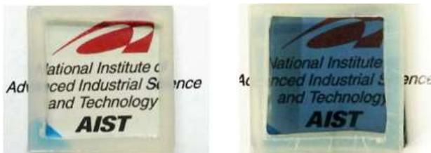
今回開発した調光膜の水素ガス導入による色の変化例
