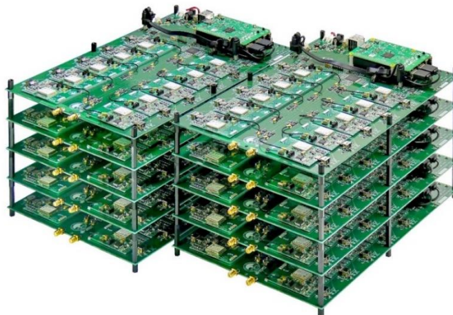
図 2 Wi-SUN FAN 無線機 100 台収納した試験環境
