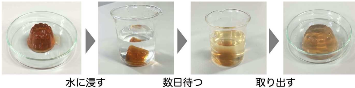
図1：水に浸した「こんにゃくゼリー」が、水を吸って膨らむ様子。こんにゃくゼリー、乾燥ワカメ、紙おむつの吸水剤などは、全て高分子のネットワークからできており、周囲の水を吸収して高分子の体積の何十倍も膨らむことができる。今回の研究では、ゼリーのようなゲルが膨らむ速度の温度変化を決める物理法則を明らかにした。
