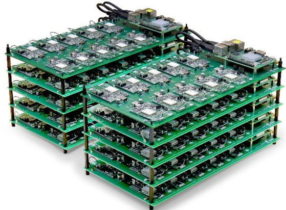
図 3 : 無線機 100 台収納した試験環境
