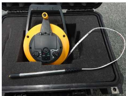
可搬型貯水槽水位計(ロープ式)
