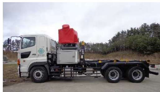
ホース展張車(9台) (ホースの保有数:屋外+屋内 約150 km)
