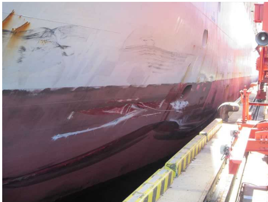
図6 本船の損傷状況（左舷船首部船側外板）
