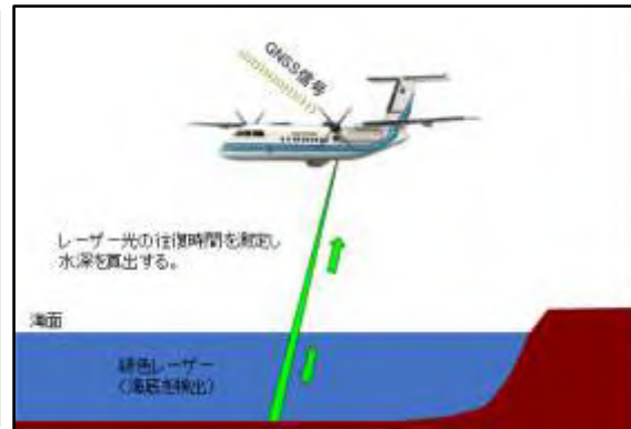
図2 航空レーザー測定の概要
